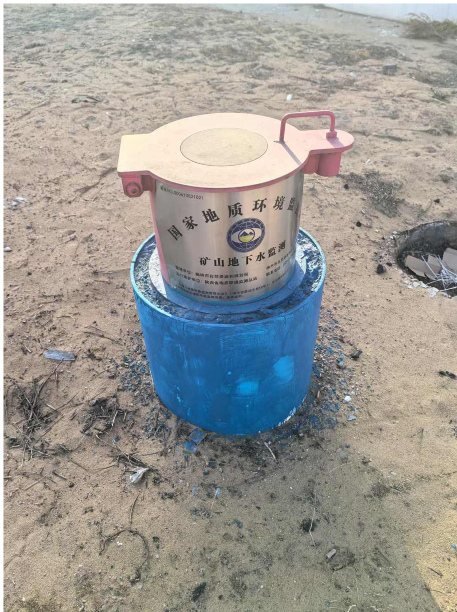
图 5.6-1 矿井地下水监测点现状
